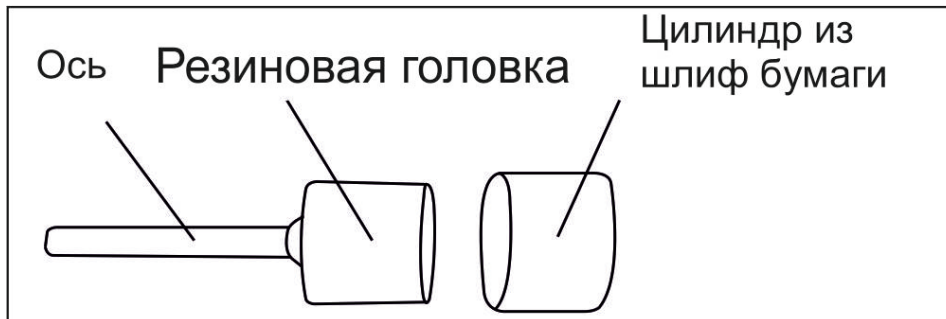
Рис.6 Установка цилиндра из шлиф бумаги
